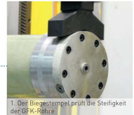
1. Der Biegestempel prüft die Steifigkeit der GFK-Rohre
