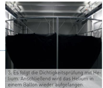
3. Es folgt die Dichtigkeitsprüfung mit Helium. Anschließend wird das Helium in einem Ballon wieder aufgefangen.
