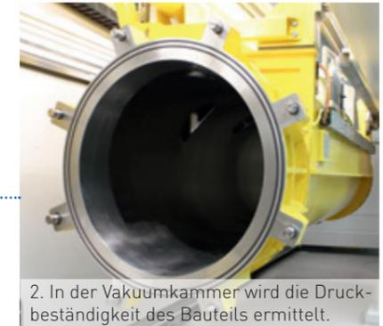
2. In der Vakuumkammer wird die Druckbeständigkeit des Bauteils ermittelt.
